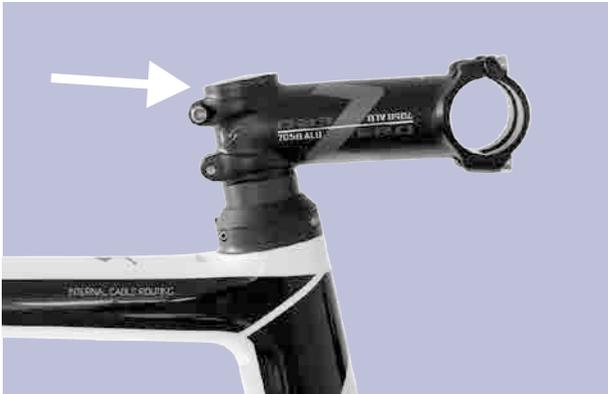
Zwischen Vorbau und Gabelschaft sollten sie Montagepaste geben. Dadurch reduziert sich das erforderliche Drehmoment deutlich und die Bauteile werden entlastet. Die Klemmschrauben des Vorbaus müssen wechselweise festgezogen werden bis sich der Lenkervorbau nicht mehr verdrehen lässt. Das maximale Drehmoment der Klemmschrauben für den Gabelschaft beträgt ca. 6 Nm.
