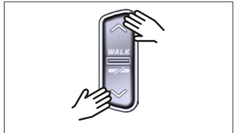
Abb. 6: Auswahl des Unterstützungsmodus auf der HPR Remote V02
