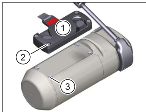
Fig. 3: Fissare il FIDLOCK® Force Connector alla Range Extender
