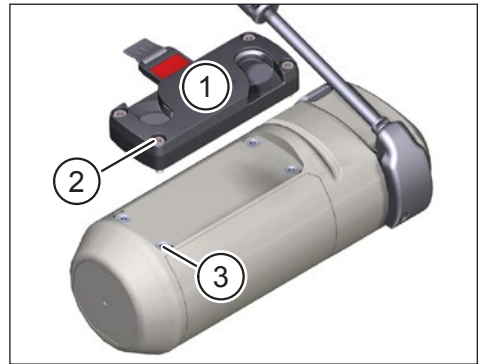
Fig. 3: Bevestig de FIDLOCK® Force Connector aan Range Extender
