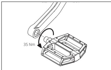
3. Tournez la pédale droite dans le filetage de la manivelle droite dans le sens des aiguilles d'une montre et serrez-la à un couple de 35 Nm.
