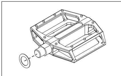
2. Tournez la pédale gauche dans le filetage de la manivelle gauche dans le sens inverse des aiguilles d'une montre et serrez-la à un couple de 35 Nm.
